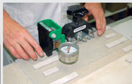
C) Prova di shear mediante apposita strumentazione (Pressometer - misuratore idraulico di forza di taglio)
