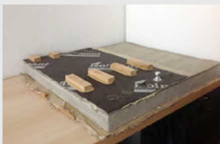
B) Provini per prove di shear su parquet incollato e provini per prove di strappo ("test dolly")
